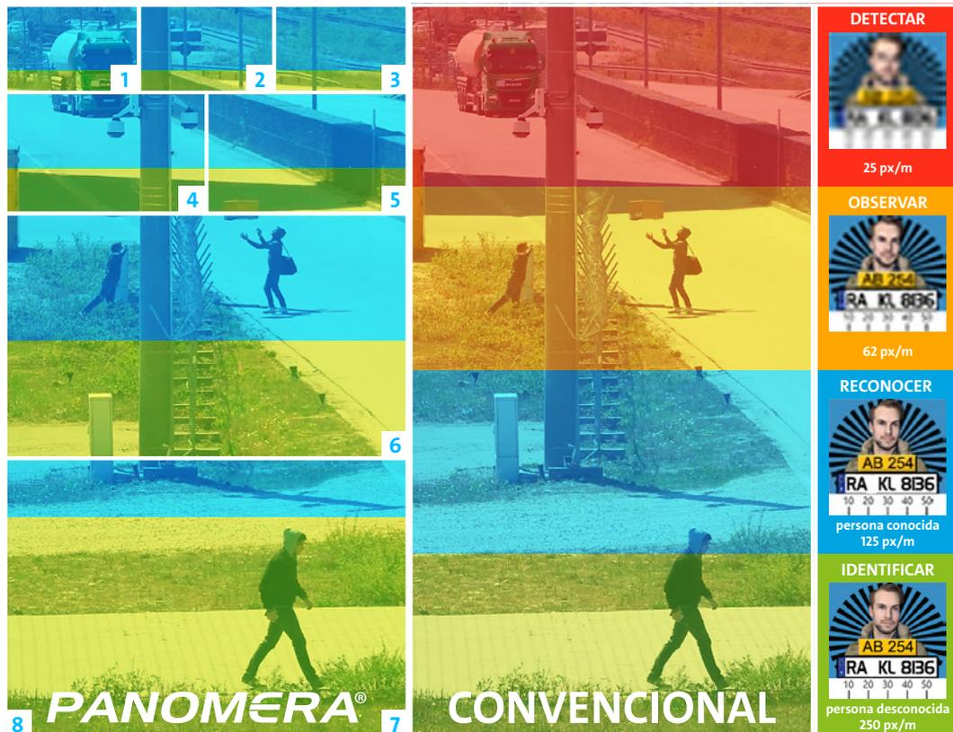
Los valores para la resolución mínima especificados en la norma DIN EN 62676-4 son la base para cualquier planificación. Con tecnología convencional, las leyes de la física se aplican con toda su fuerza. Con Panomera®, se puede lograr una distribución mucho más uniforme de la resolución en todo el espacio de objeto.
