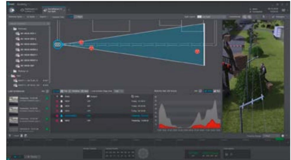
Uno de muchos ejemplos de análisis de vídeo moderno: La clasificación de objetos basada en IA sólo transmite aquellas alarmas que realmente requieren la verificación humana.
