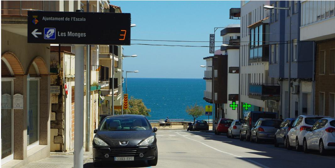
**U-Display** permite guiar a los conductores cuando se acercan a las zonas de aparcamiento, informándoles sobre las plazas libres disponibles. Gracias a sus módulos de LEDs numéricos o alfanuméricos y a su diseño personalizado, U-Display ofrece una forma sencilla y flexible de implementar una solución eficiente de guiado de parking, tanto para entornos urbanos como privados.
