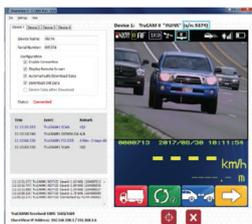
Control remoto mediante PC para visualizar capturas y descargar infracciones
