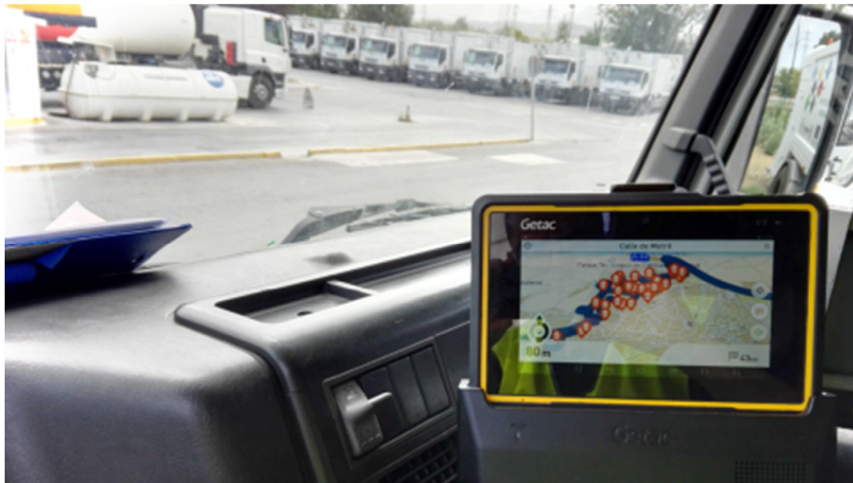
Figura 1. Imagen del navegador a bordo con el sistema de optimización de rutas.
