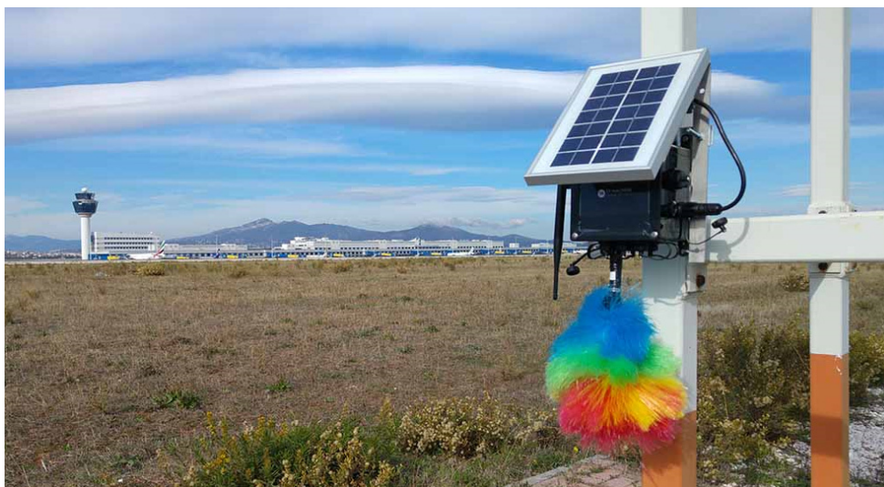
Figura 4. Dispositivo de sensores para medir el nivel de ruido en la pista del Aeropuerto Internacional de Atenas.
