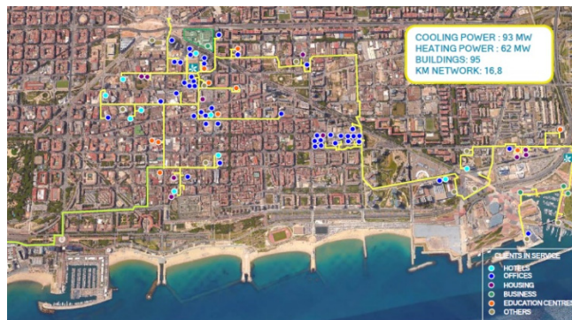
Figura 5. Red de calefacción y refrigeración urbana 'Districlima' en Barcelona, a la cual se han conectado diversos edificios dentro de GrowSmarter. [7]
