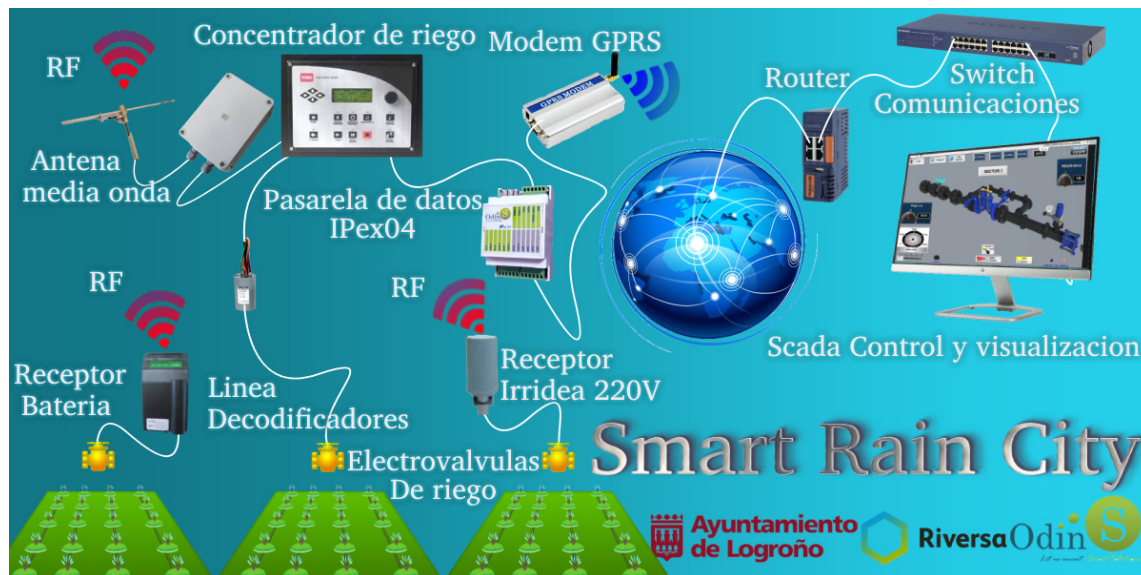
Figura 3. Esquema de conexiones de solución Smart Rain II.
