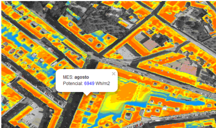
Figura 4. Valor del potencial solar fotovoltaico para un punto de la cubierta en el mes de agosto.
