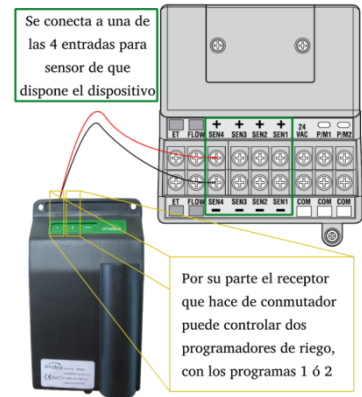
Figura 4. Esquema de conexión de el conmutador inalámbrico a los programadores antiguos de riego.
