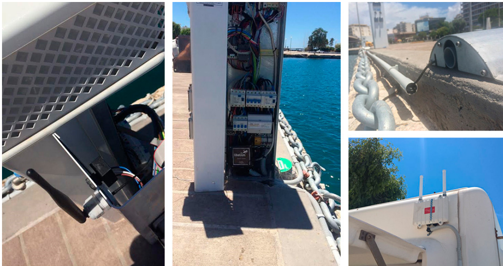
Figura 2. Nodos instalados en el puerto de Patras para monitorizar la actividad de las embarcaciones.
