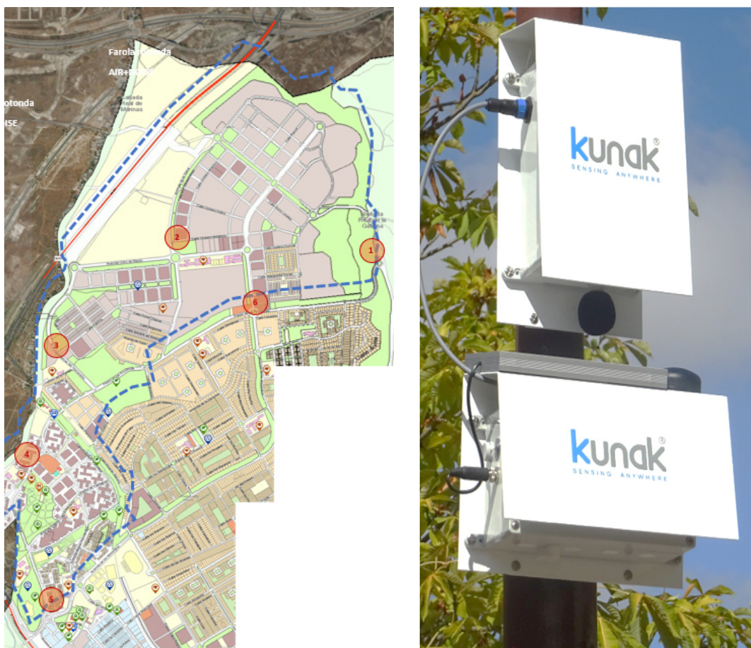
Figura 3. Unidad smart de monitorización de calidad del aire y ruido area actuación E-DUSI.
