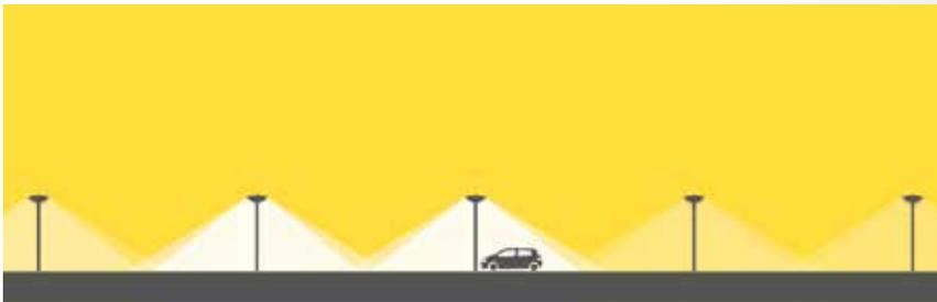
La iluminación adaptativa permite cambios en los niveles de luminancia e iluminación controlados en relación al volumen de tráfico, la hora, y condiciones meteorológicas.
